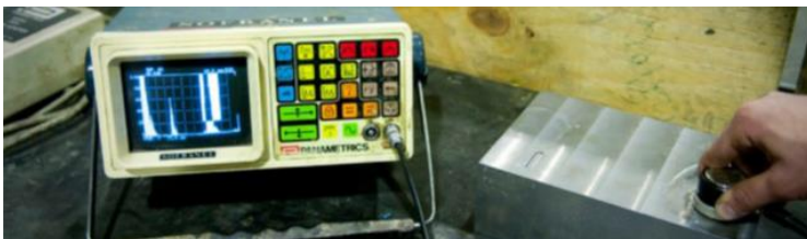
Test ultrasons (UT)
